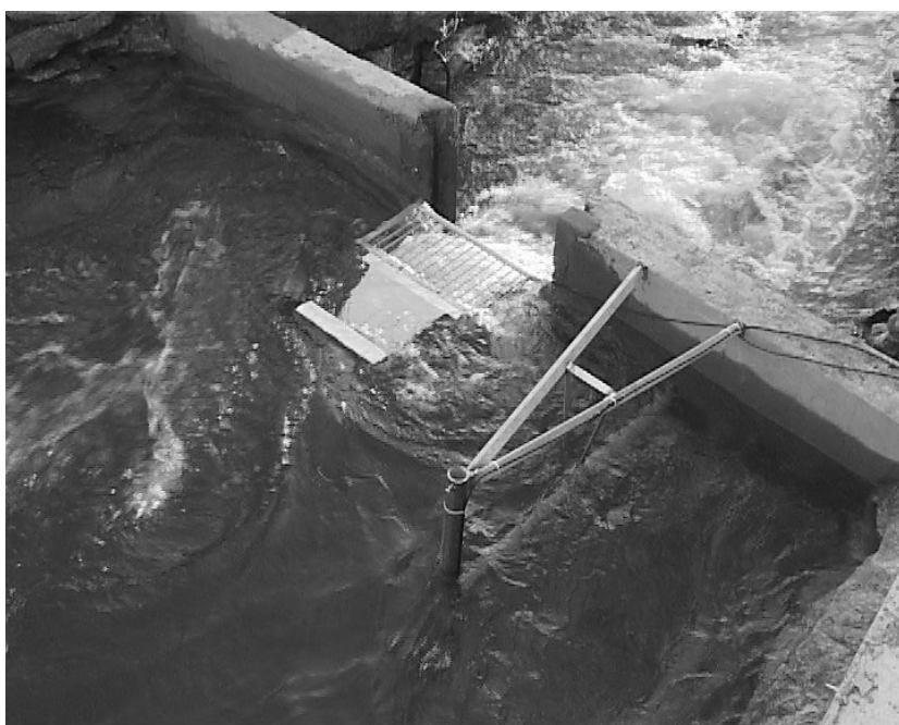
Figur 14. Mekanisk fisketeller med undervannsvideokamera i trapp i Kistefossen i Salangselva i Troms.
