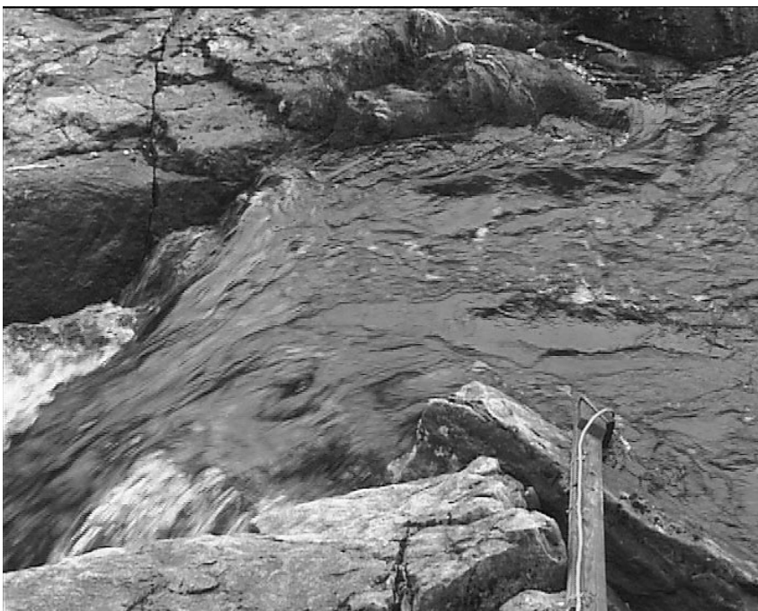
Figur 10. Passeringspunktet for fisk i Storfossen i Øyensåa. Tverrsnittet var ca 2,5 x 1,0 m og ble overvåket av undervannsvideokamera.
