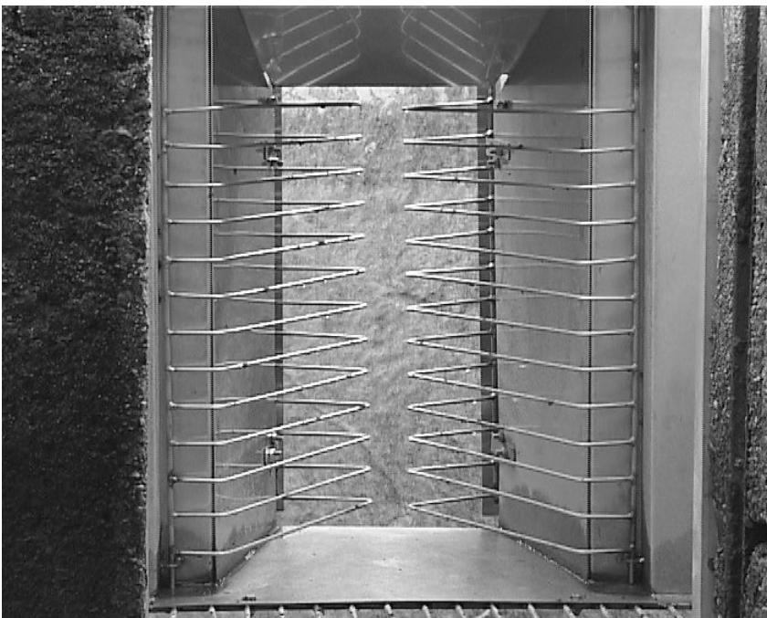
Figur 1. "Dørene" i den mekaniske fisketelleren som ble benyttet i fisketrapper. Fisken kommer i kontakt med spilene av rustfritt stål, som ved åpning slutter en bryter.
