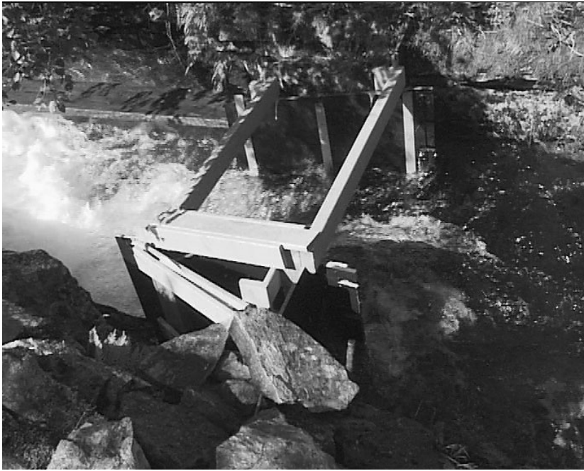
Figur 7. Registreringselektrodene for Logitelleren i Osfossen i Gaular i Sogn og Fjordane var festet til en treramme.
